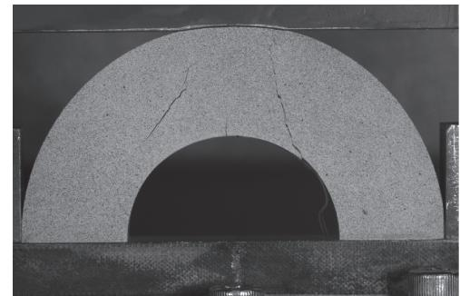
图 9 强约束条件下试件裂纹的形貌
